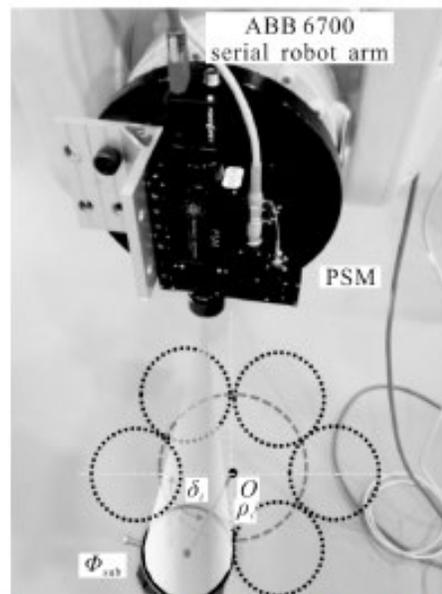
图 4 串联机械臂以及 PSM
